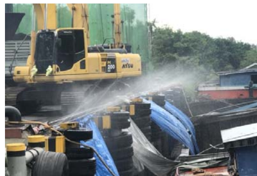
รูปที่ 2-14 ภาพการฉีดน้ำขณะขนถ่ายสินค้า
