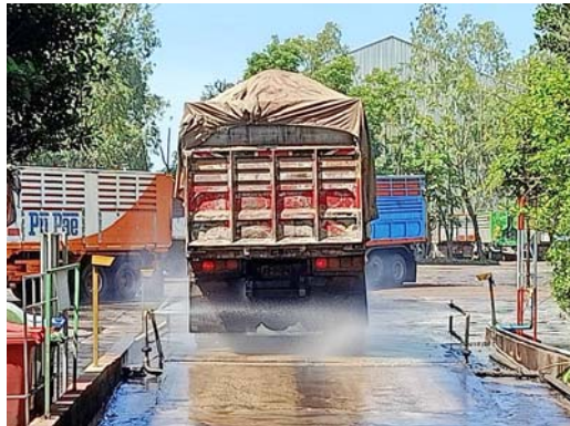
รูปที่ 2-11 การล้างล้อรถบรรทุก
